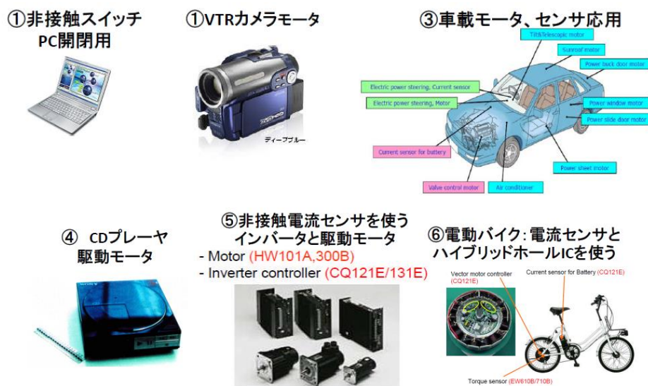
Fig.5 身の回りで使われる高感度薄膜ホール素子の応用例
