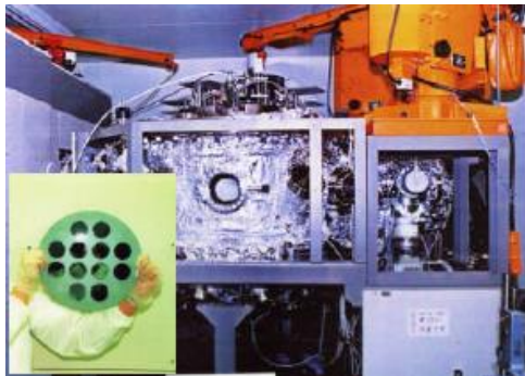
Fig.4 単結晶や量子井戸を製作する分子線エピタキシー（MBE）装置写真 （左下写真は、製作した厚さ0.5 \mu mのInAs単結晶薄膜）
